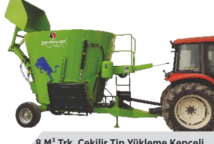
8 M³ Trk. Çekilir Tip Yükleme Kepečli
