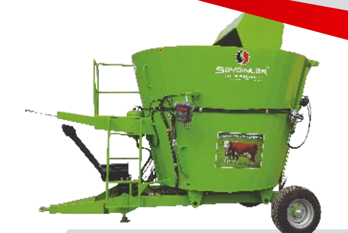
8 M³ Trk. Çekilir Tip Yükleme Kepečli
