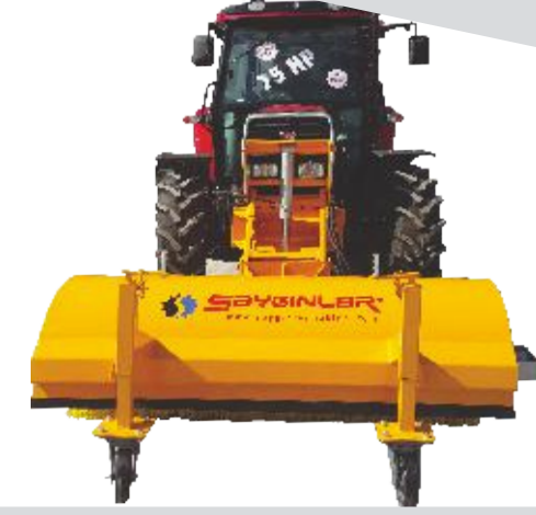
Traktörden Hareketli Sağa - Sola Açılı Model
