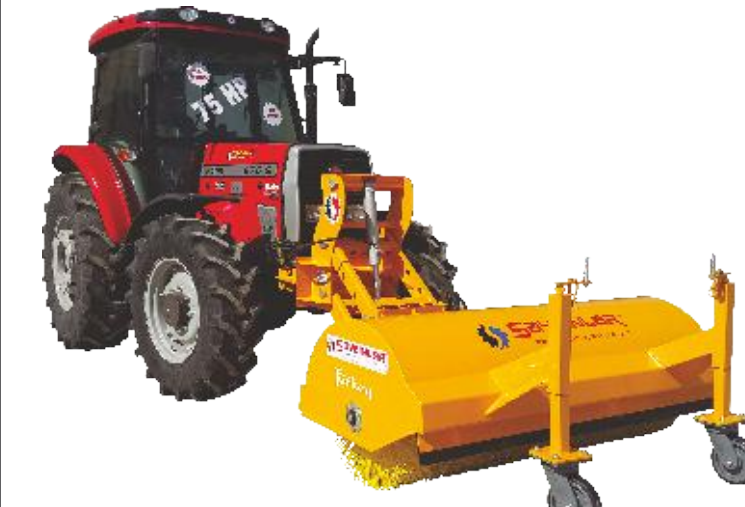
Yol Süpürme Makinesi Traktör Ön Tractor Front Mounted Road Sweeper
